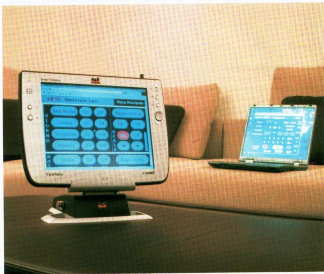
Primo piano di uno dei touch screen che gestisce il sistema. Notare la videata con la rappresentazione dei vari comandi
